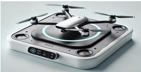
최대 비행시간 확보를 위한 차징 스테이션 자동 충전 적용(배터리 교환 방식)
